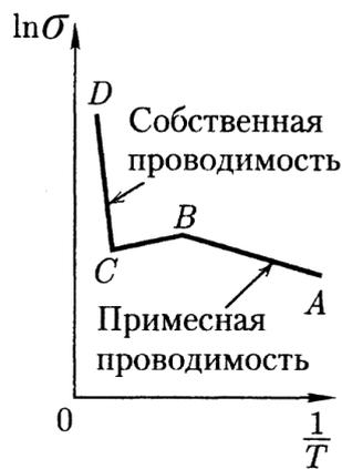
Рис. 8.6. Определение энергии активации по температурной зависимости  $\sigma(T)$ . Участок  $AB$  описывает примесную проводимость полупроводника. Рост примесной проводимости с увеличением температуры обусловлен в основном повышением концентрации примесных носителей в зоне проводимости. Участок  $BC$  соответствует области истощения примесей, участок  $CD$  описывает собственную проводимость полупроводника.
