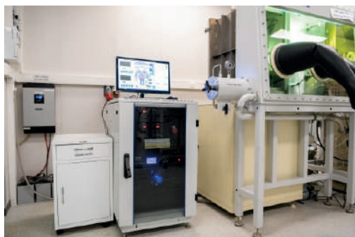
Установка терморезистивного испарения EPOS-PVD-FLAT – 4 источника (2 для органических материалов; 2 для металлов) для контролируемого напыления органических и оксидных транспортных слоев
