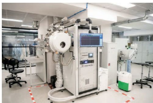
Установка ионно-лучевого напыления для формирования прозрачных проводящих покрытий Beams&Plasmas НИКА'13 (ITO, AZO, IZO с площадью до 200×200 мм).
