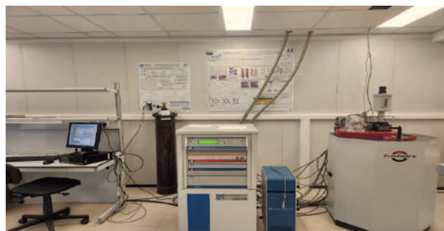
Система для измерения физических свойств “Quantum Design” Physical Properties Measurements System PPMS-9T
