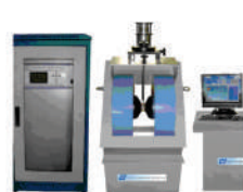
Вибромагнитометр VSM-250 фирмы LDJ, Китай
