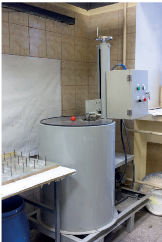
Смесители для приготовления огнеупорной суспензии MZJ60 с охлаждаемой лопастью
