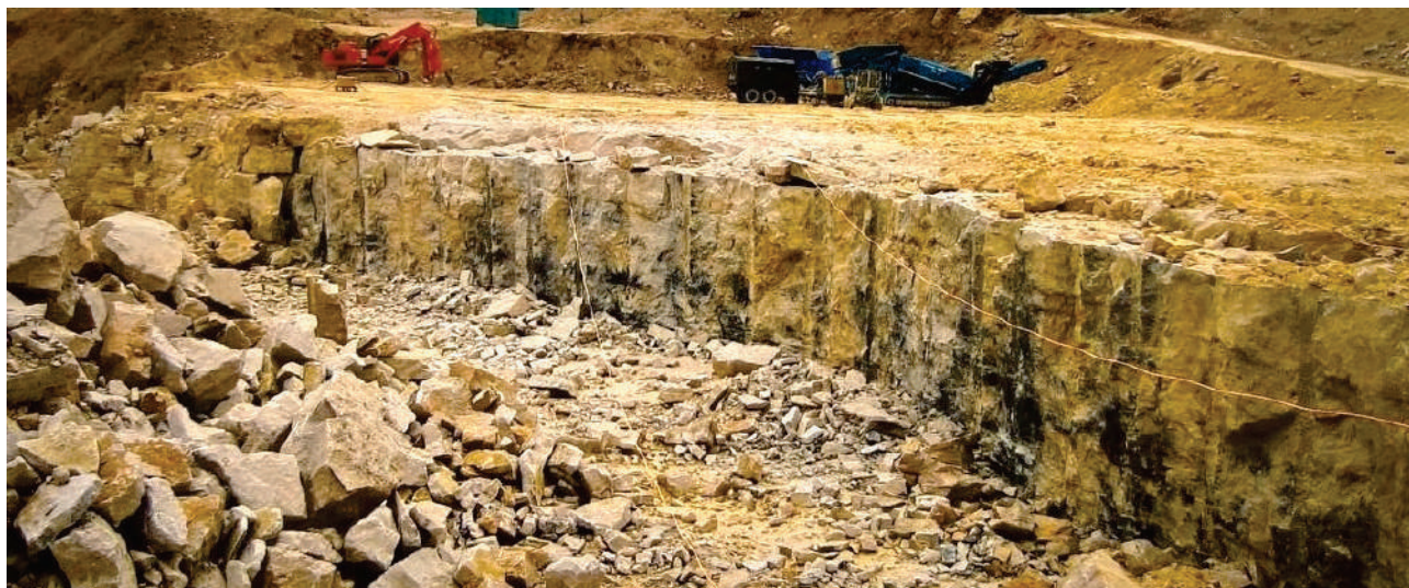
Экспериментальный взрыв со смещением отделенной полосы от массива на 5,7 м
