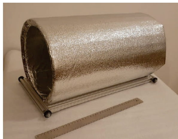
Рисунок 15 – Структурная схема и общий вид изготовленного магнитного экрана.
