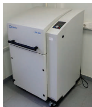
Высокоэнергетическая шаровая планетарная мельница Retsch PM 400
