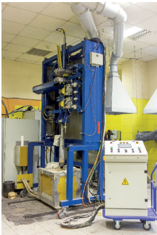
Портальная установка вертикального литья вверх ПУВЛ-450 с индукционной тигельной печью
