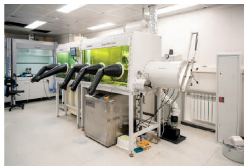
Система перчаточных боксов с инертной средой СПЕКС ГБ (содержание O 2 < 1 ppm, содержание H 2 O < 1 ppm)
