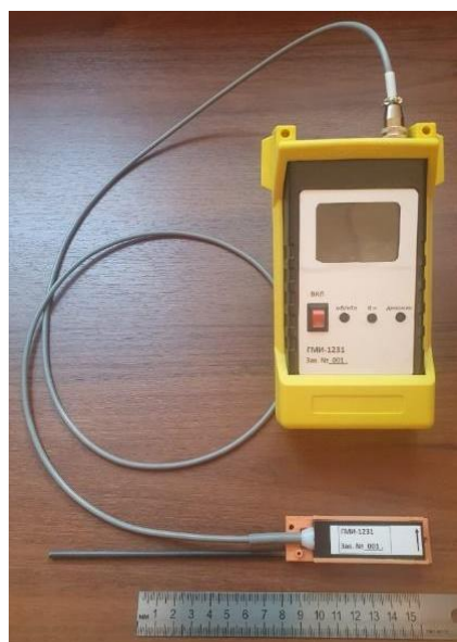
Рис.19. Прототип однокомпонентного ГМИ магнитометра.
