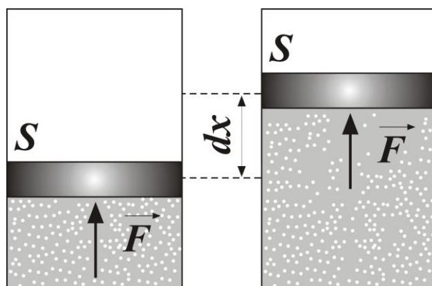
Рисунок 2.1. Изобарическое расширение газа в цилиндре под поршнем.
