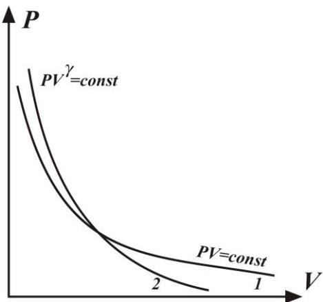
Рисунок 2.3. Графики изотермического и адиабатического процессов:
