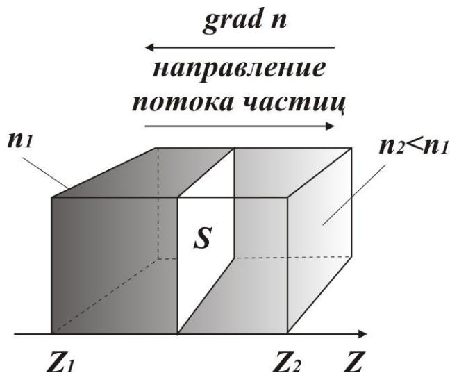
Рисунок 5.3 Процесс диффузионного переноса вещества.
