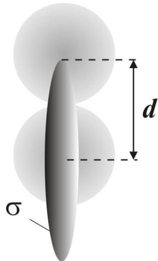
Рисунок 5.1 Сечение рассеяния при столкновении молекул.
