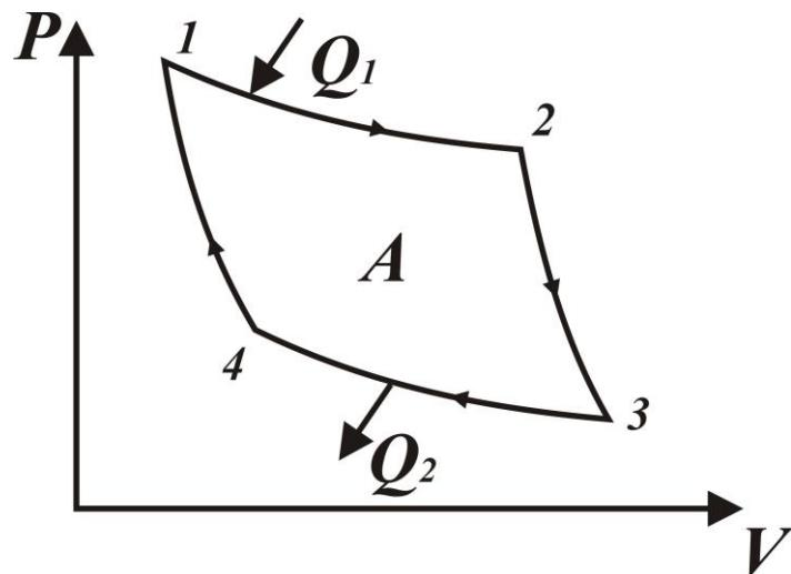
Рисунок 3.1 Цикл идеальный тепловой машины Карно.
