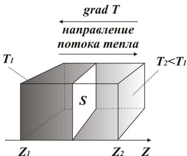
Рисунок 5.2 Процесс переноса тепла в твердом теле.
