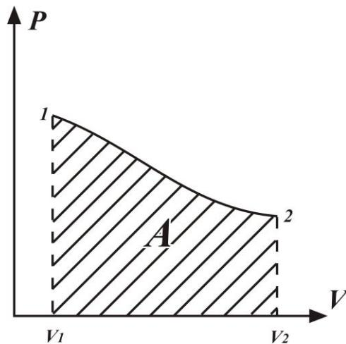
Рисунок 2.2. Геометрический смысл работы, производимой газом, для процесса, отображенного на координатах PV.
