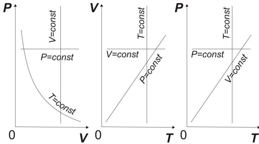
Рисунок 1.1 Графики изопроцессов.
