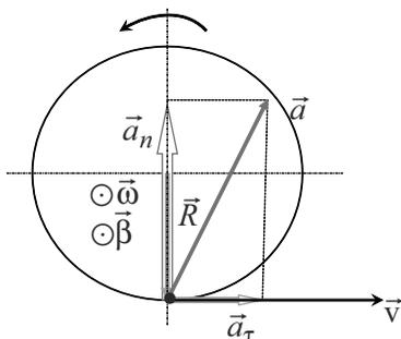
Рис. 1.1.6. Линейные и угловые характеристики ускоренного осевого вращения абсолютно твердого тела (или орбитального движения материальной точки)
