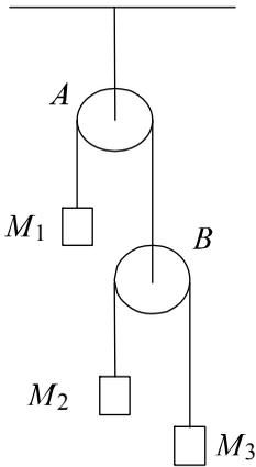
Через невесомый блок  $A$  перекинута нить, к одному концу которой прикреплен груз  $M_1$ , а к другому невесомый блок  $B$ , на нити которого висят грузы  $M_2$  и  $M_3$ . Блок  $A$  со всеми грузами подвешен к пружинным весам. Определите ускорение  $a$  груза  $M_1$  и показание  $T$  пружинных весов, считая, что  $M_2 \neq M_3$ ,  $M_1 > M_2 + M_3$ .
