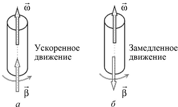
Рис. 1.1.5. Векторы угловой скорости и углового ускорения при ускоренном (а) и замедленном (б) вращениях
