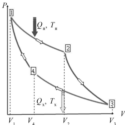
Рис. 2.3.1. График цикла Карно
