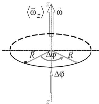
Рис. 1.1.4. Векторы углового перемещения  $\Delta\vec{\varphi}$  и угловой скорости  $\vec{\omega}$
