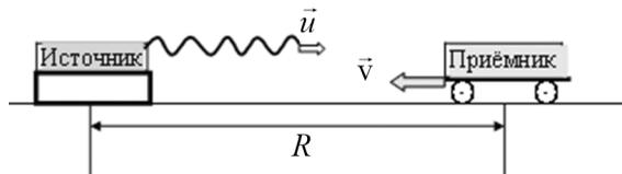
Рис. 1.5.2. Эффект Доплера: приемник движется
