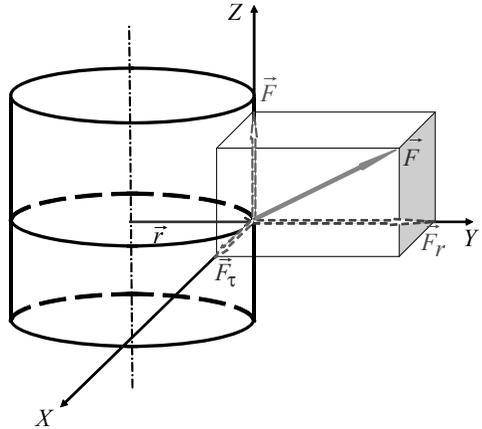
Рис. 1.2.5. Разложение силы  $\vec{F}$  по осям координат
