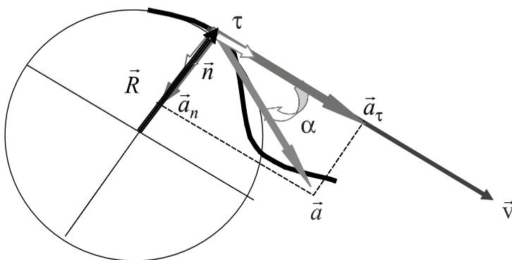
Рис. 1.1.1. Тангенциальное и нормальное ускорения при ускоренном движении
