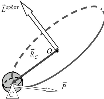
Рис. 1.2.3. Орбитальный момент импульса материальной точки
