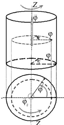
Рис. 1.1.3. Простое (осевое) вращение абсолютно твердого тела;  $\vec{\varphi}$  – вектор угла поворота
