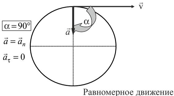
Рис. 1.1.2. Тангенциальное и нормальное ускорения при равномерном движении материальной точки по окружности
