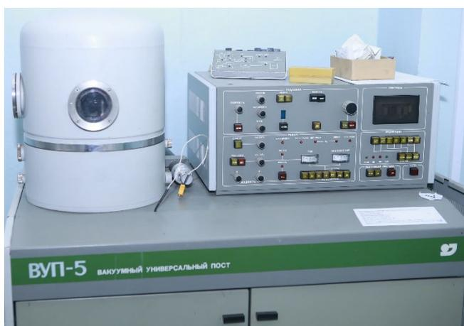
Рисунок 26 – Установка вакуумно-универсального поста ВУП-5
