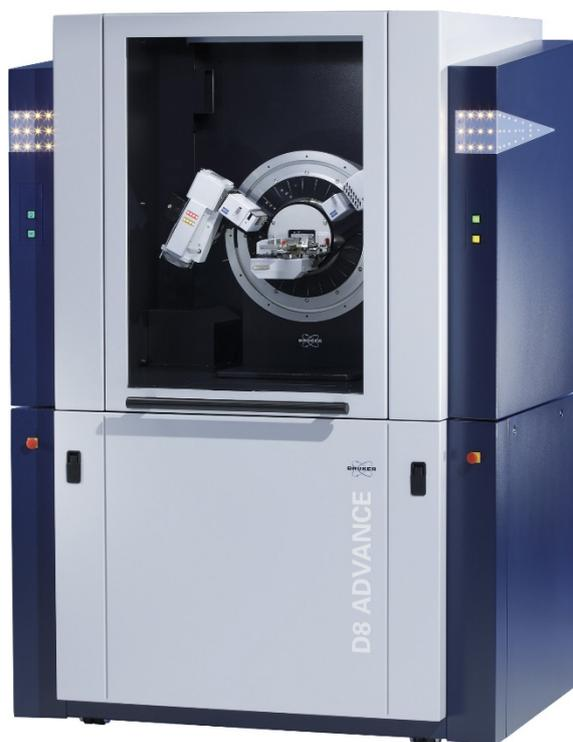
Рисунок 34 – Внешний вид дифрактометра Bruker D8 Advance
