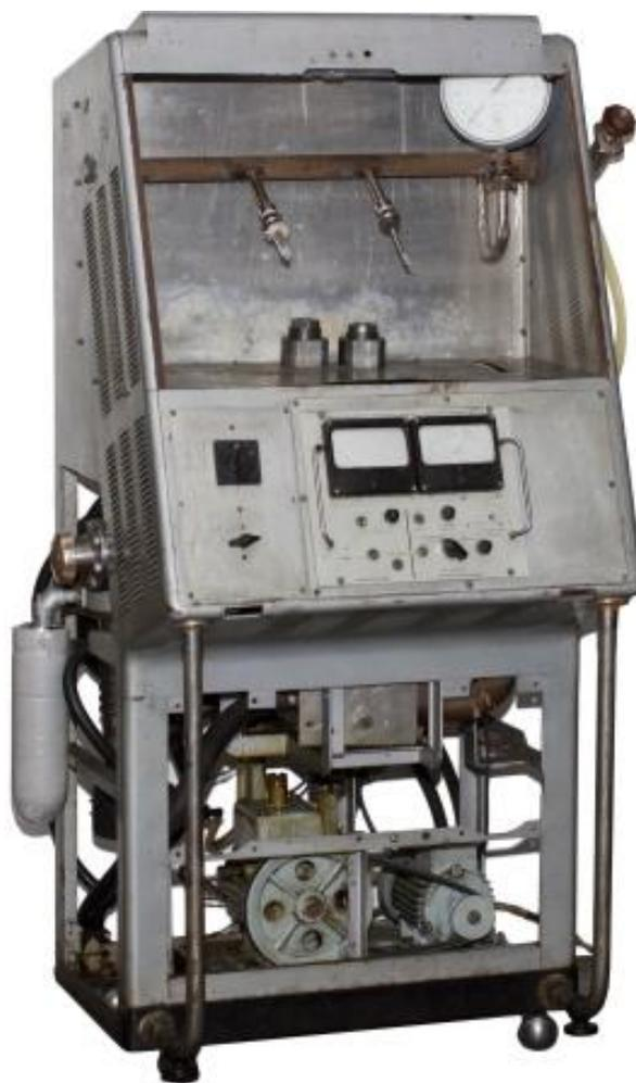
Рисунок 31 - Внешний вид вакуумного откачного поста ВП-5
