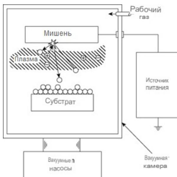
Рисунок 25 - Основной процесс напыления
