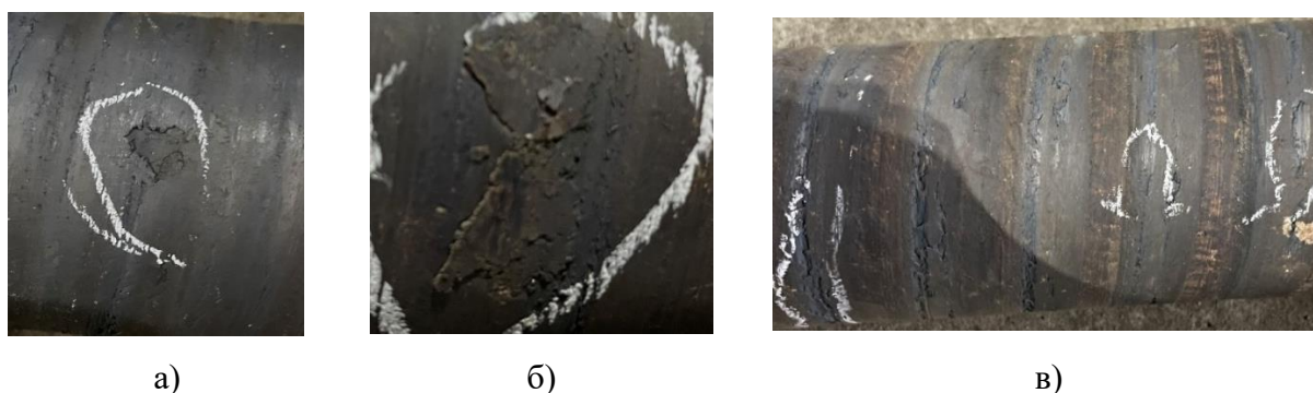
Рисунок 42 – Поверхностные дефекты: а) задыр; б) налипание на поверхность металла; в) канавки, образовавшиеся от направляющих линеек
