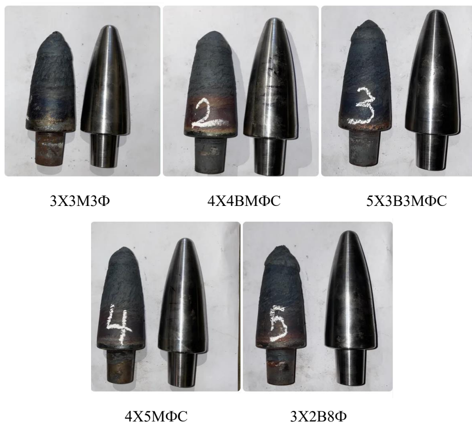
Рисунок 1 – Состояние поверхности оправок после прошивки 3-х заготовок в сравнении с изначальным профилем
