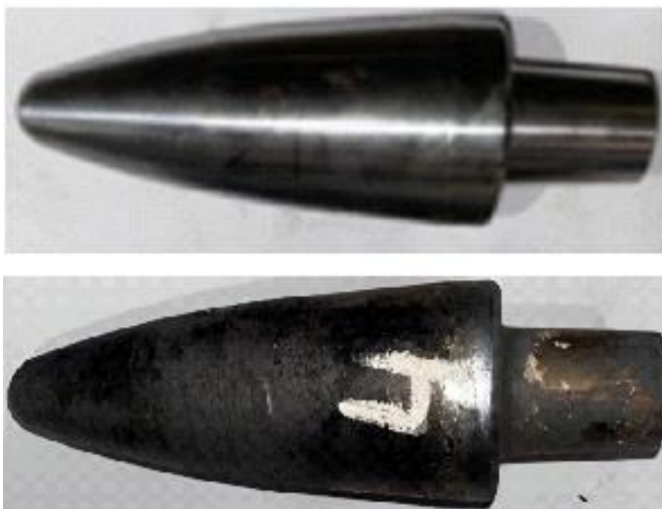
Рисунок 12 – Оправка из стали 4X5МФС после одного прохода
