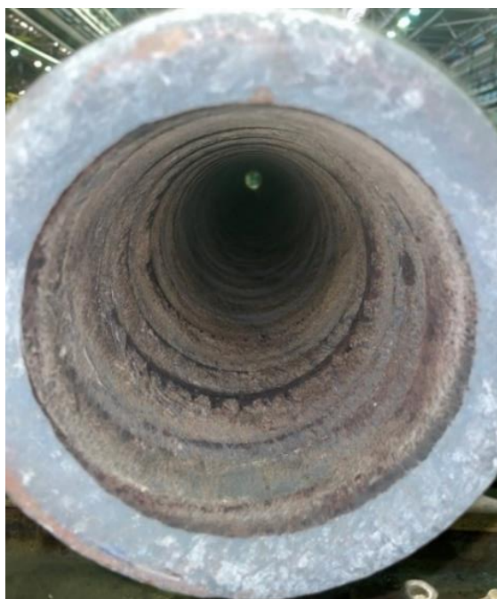
Рисунок 69 – Винтовые бороздки на внутренней части трубы
