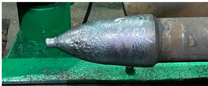
Рисунок 62 – Состояние поверхности прошивной оправки
