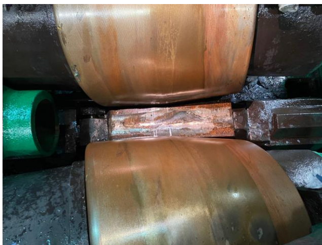
Рисунок 60 – Состояние поверхности нижней линейки
