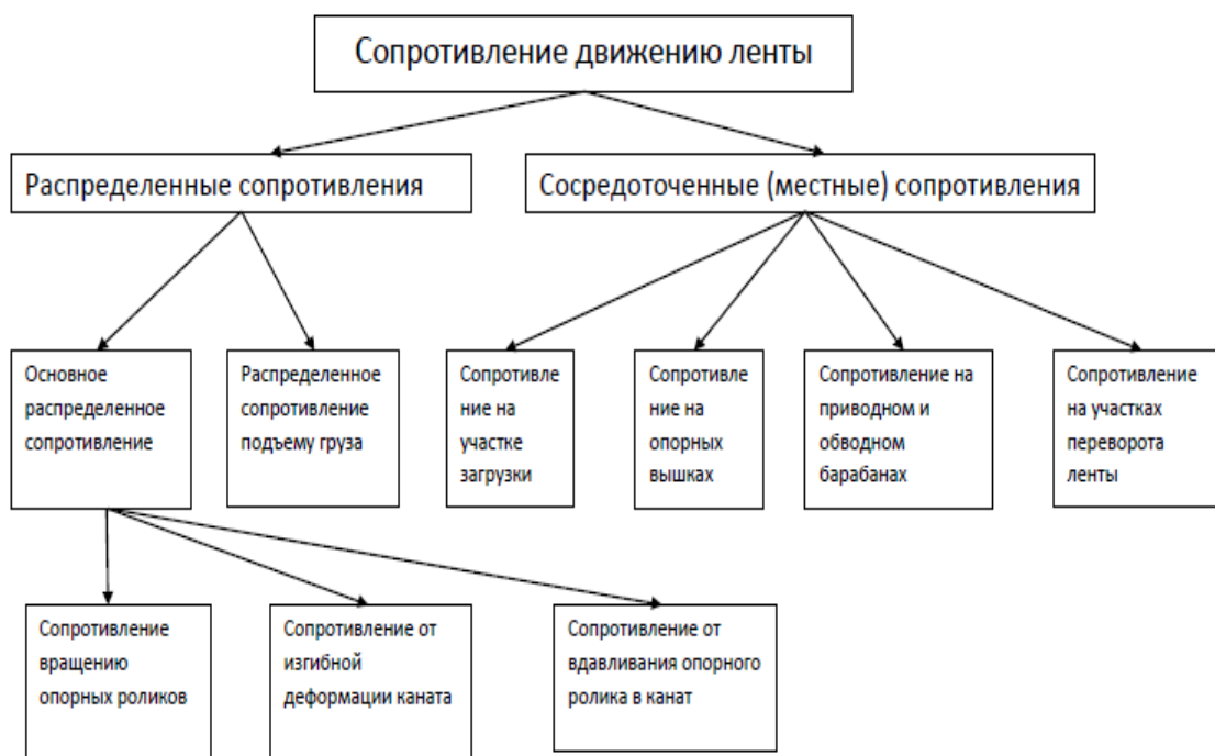
Рисунок 3.1 - Виды сопротивлений движению тягового органа ПКК и структура полного сопротивления
