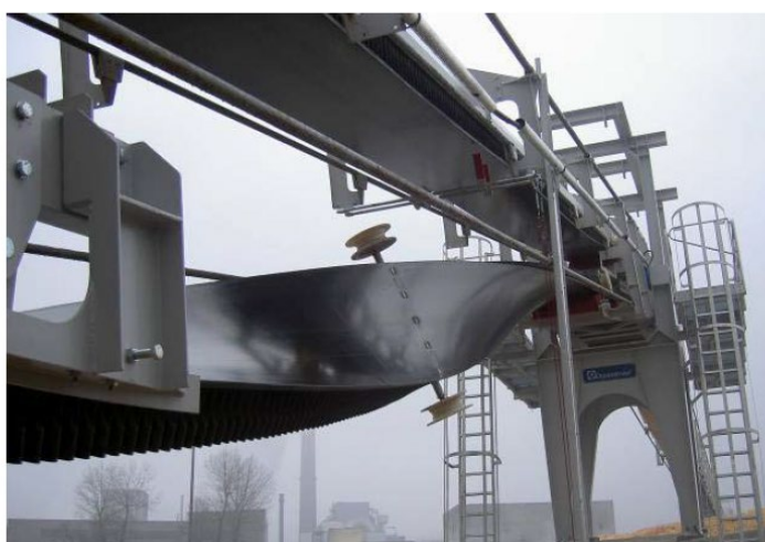
Рис. 2.5 – Неуправляемый переворот гофроленты на конвейере типа RopeCon® в Верхней Австрии [49]
