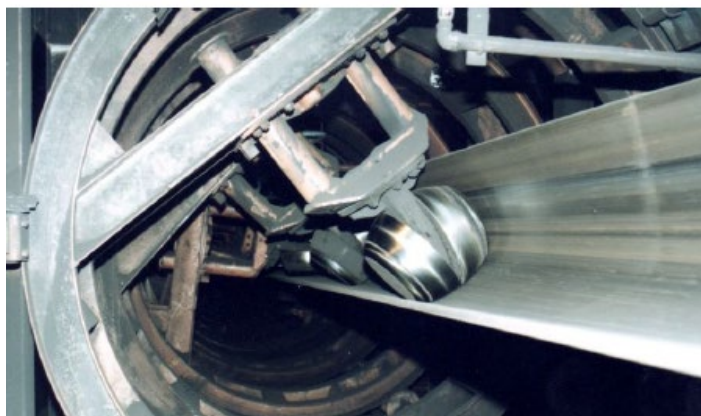
Рис. 2.6 – Переворот ленты в направляющих опорах для осевой линии [57]
