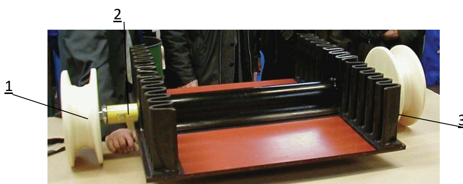
1-ходовые ролики; 2- ось роликов; 3-лента с гофрированными бортами Рисунок 1.5 - Ходовые ролики с осью в сборе с конвейерной лентой: [1]
