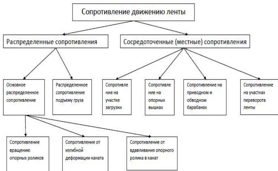
Рисунок А3. Виды сопротивлений движению ленты конвейера RopeCon® и структура полного сопротивления её движению
