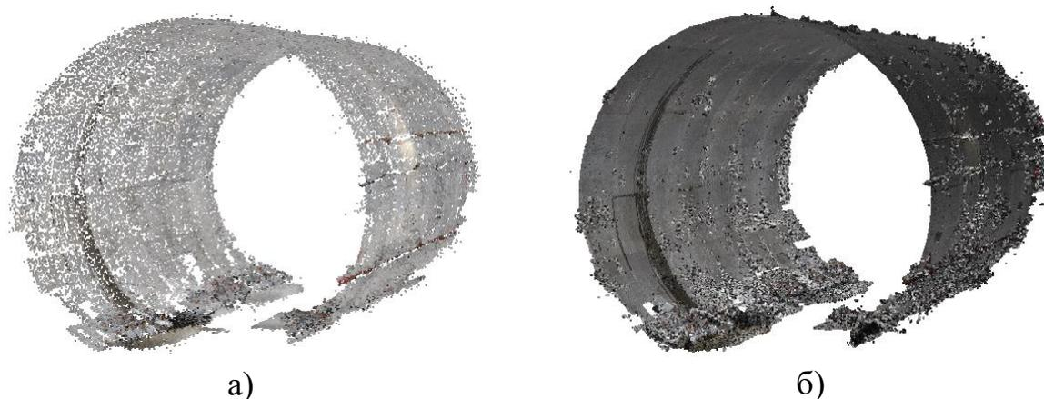
Рисунок 3.9 – Этапы построений при камеральной обработке: а) разреженное облако точек; б) плотное облако точек.
