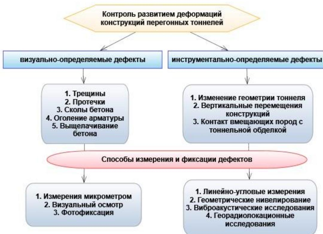
Рисунок 1.2 - Структура контроля дефектов тоннельной обделки
