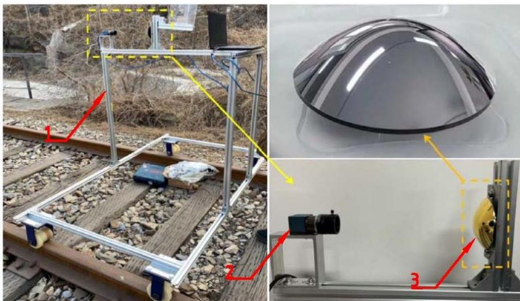
Рисунок 1.10 - Гиперboloидная катадиоптрическая панорамная система визуализации: 1 – инспекционная платформа; 2 – промышленная камера; 3 – гиперболическое зеркало [37]
