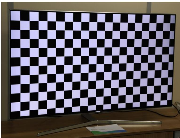
Рисунок 3.1 - Калибровочная таблица, представленная на ЖК-экране [96]
