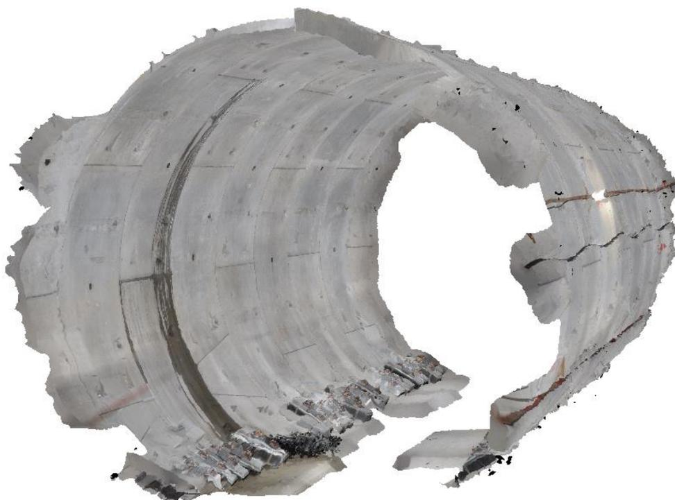
Рисунок 3.10 - ЦМТ исследуемого участка перегонного тоннеля, построенная на основе плотного облака точек после удаления точек «шума»
