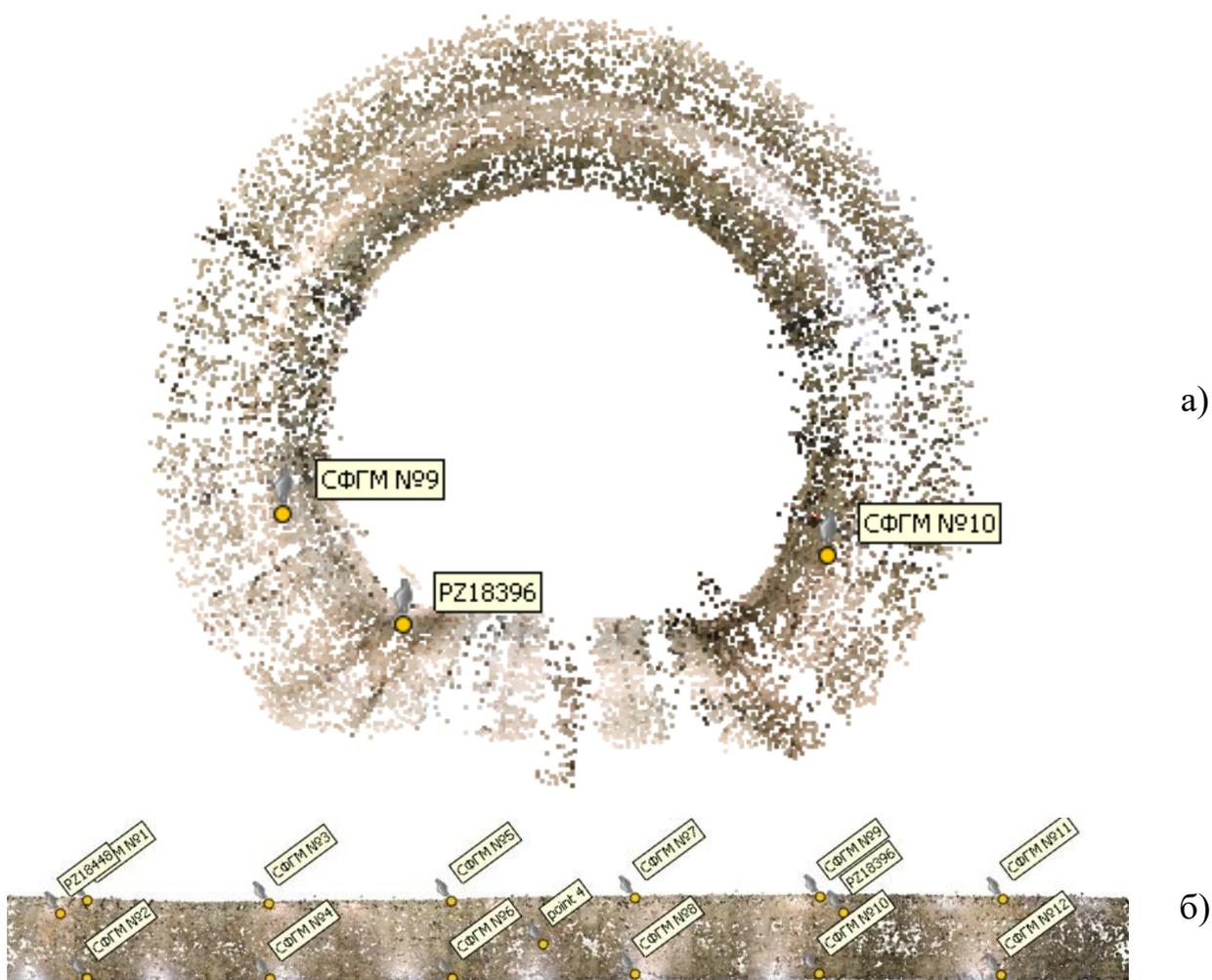
Рисунок 3.17 - Визуализация связующих точек 50-метрового прямолинейного участка перегонного тоннеля:
