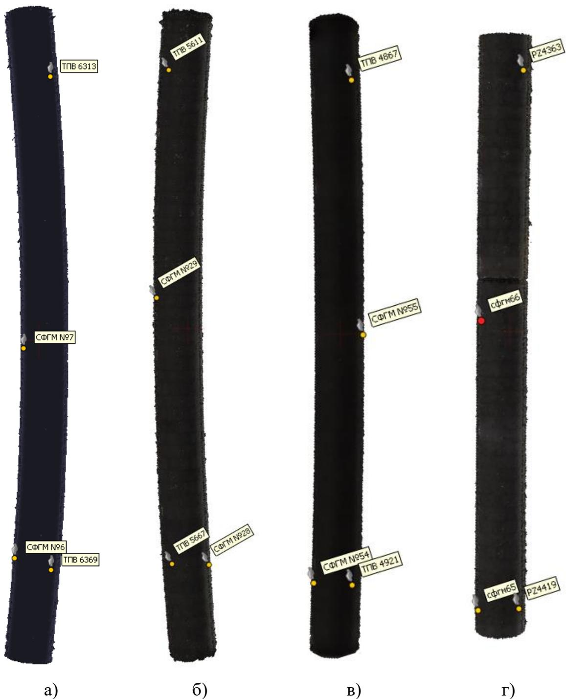
Рисунок 4.6 - Построенные ЦМТ 50-метровых участков перегонного тоннеля с опорными знаками: а)  $R=350$  м; б)  $R=500$  м; в)  $R=1000$  м; г)  $R=3000$  м [98]
