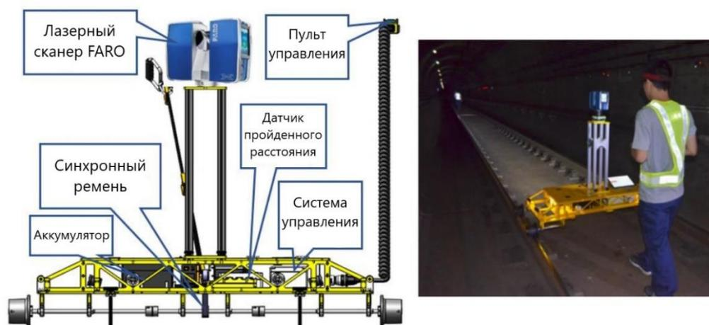
Рисунок 1.7 - Структура мобильной сканирующей системы (слева) и процесс выполнения работ (справа) (по материалам [34])
