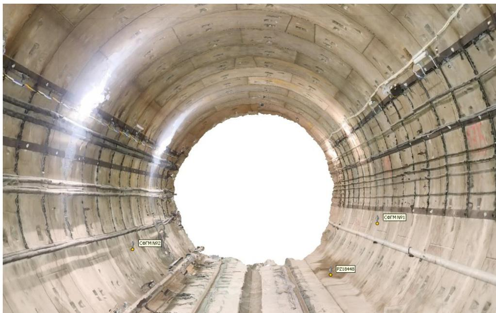
Рисунок 3.22 - Фрагмент ЦМТ 50-метрового тестового участка перегонного тоннеля, построенного на основе плотного облака точек
