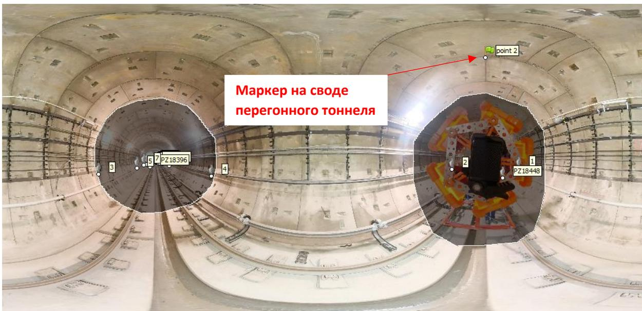
Рисунок 3.29 - Схема размещения маркера на своде тоннеля (Point 2)
