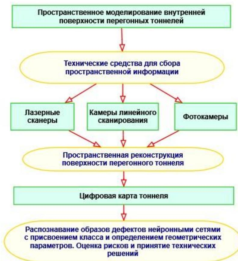
Рисунок 1.1 – Структура пространственного моделирования внутренней поверхности перегонных тоннелей для отслеживания технического состояния перегонных тоннелей метрополитена (по материалам [1])
