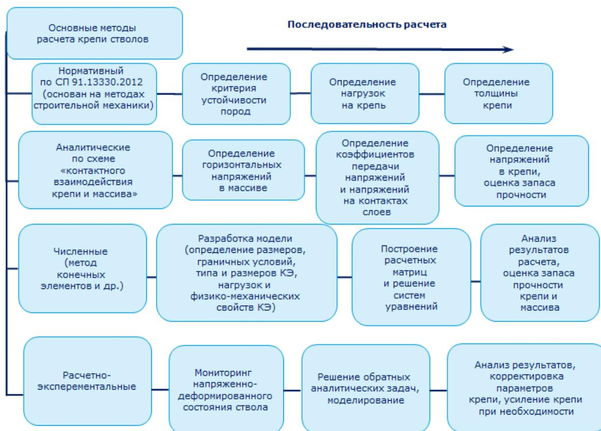
Рисунок 1.3.1 – Порядок реализации методов оценки устойчивости и расчетов крепи шахтных стволов на участках сопряжений
