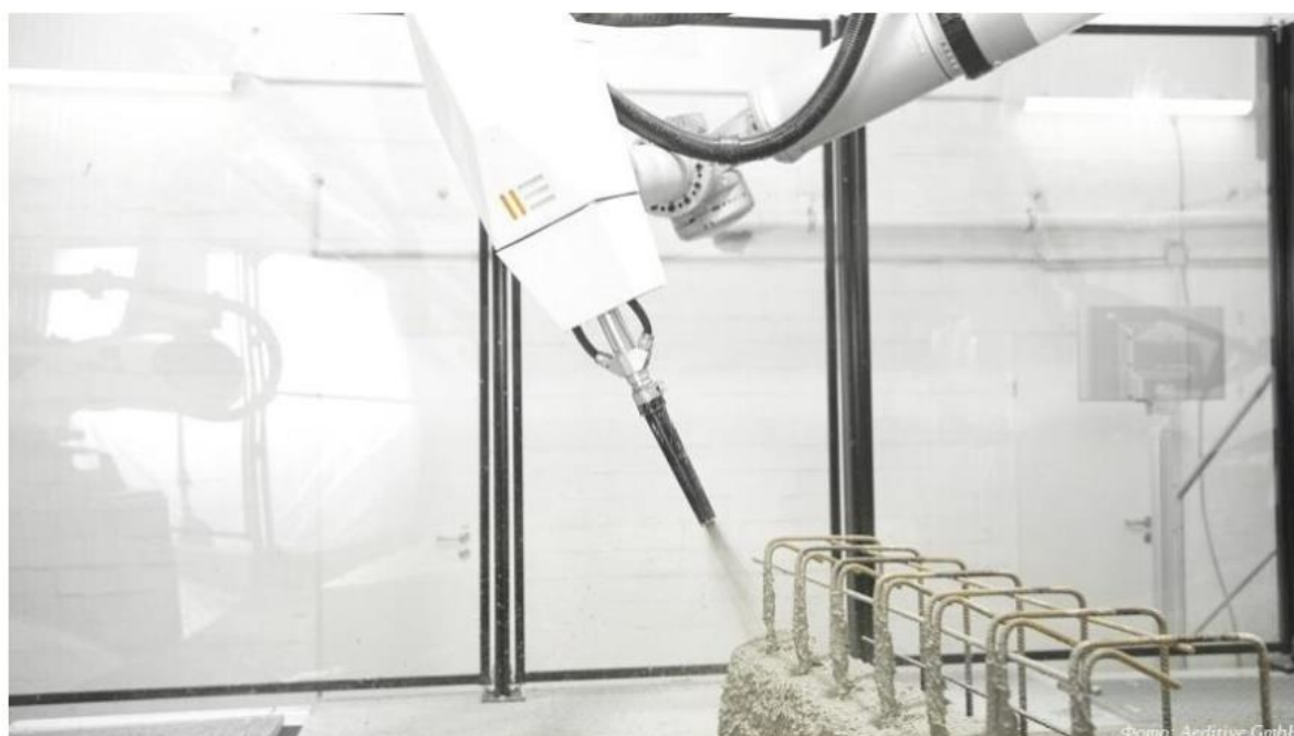
Рисунок 1.2.2 – Аддитивная технология нанесения торкрет-бетона (фото с сайта https://www.aeditive.de )
