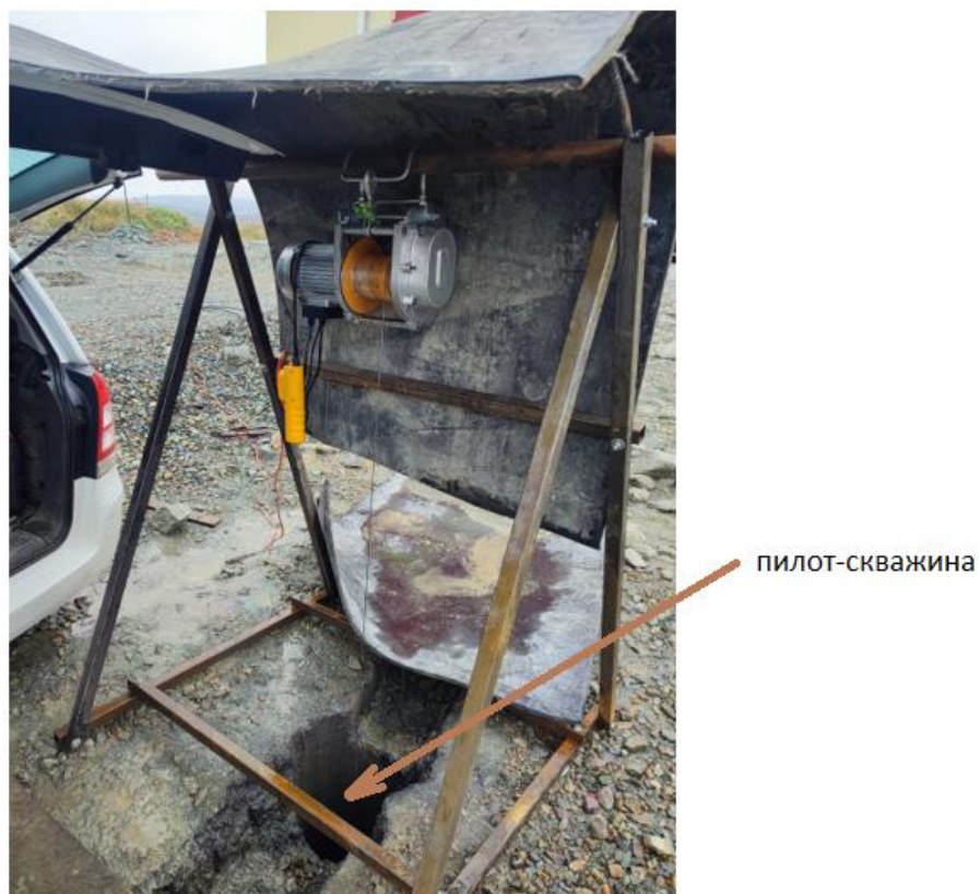
Рисунок 2.2.1 – Лебедка для спуска-подъема видеозонда
