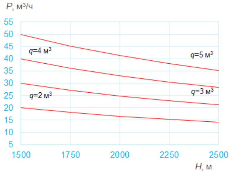
Рисунок 1.1.1 – Графики зависимости проходческого подъема от глубины стволов при различной вместимости бадей
