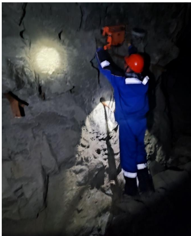
Рисунок 2.2.11 – Рабочий процесс георадарной съемки антенным блоком АБ-400
