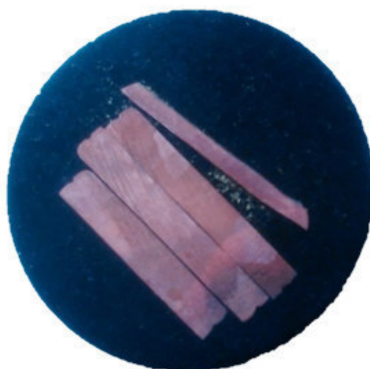
Рисунок 17 – Образцы, после процедур запрессовки в смолу, шлифовки, полировки и химического травления
