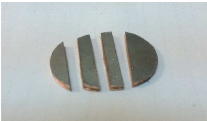
Рисунок 16 – Образец, нарезанный после диффузионного отжига
