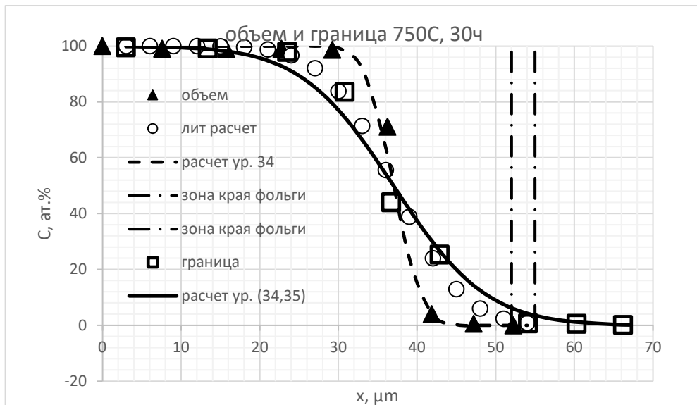
Рисунок 24 – Концентрационные профили Ni-Cu при 750 °C и 30 ч объемная диффузия и ЗГД. (Штрих-пунктирные вертикальные линии рядов 5,6 обозначают интервал 15-18 мкм от границы раздела, в который попадают значения, измеренные на фольгах при этих же параметрах отжига)
