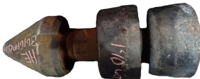
Рисунок 4.19 – Оправочный узел после второго прохода прокатки
