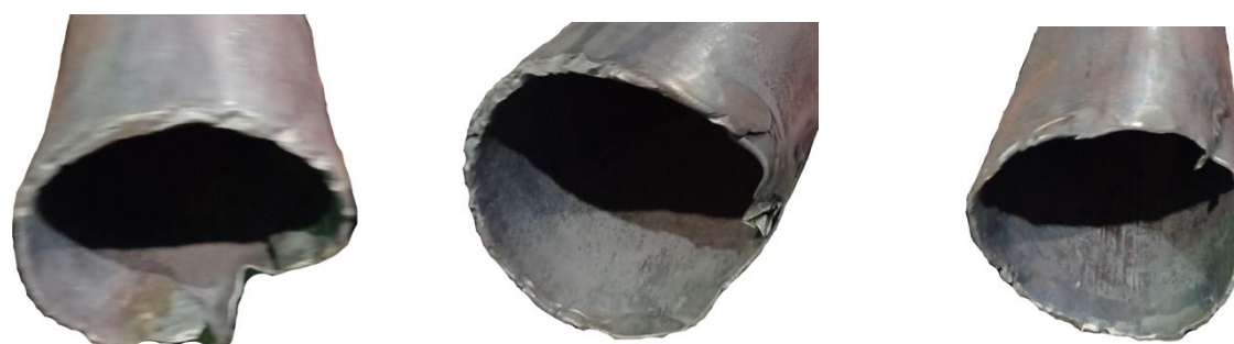
Рисунок 4.14 – Трубы на охлаждающем столе после экспериментальной прокатки на ТПА 220 при использовании дополнительной втулки [50]
