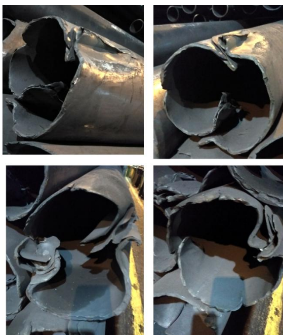
Рисунок 1.6 – Готовые трубы с концевыми складками
