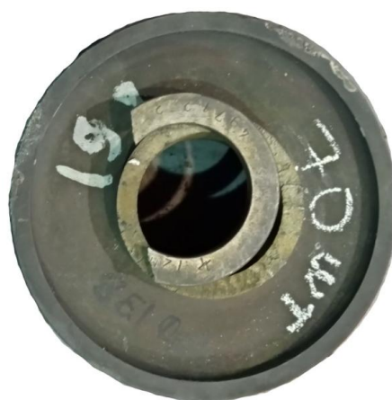
Рисунок 4.16 – Втулка первого прохода после 70 проходов
