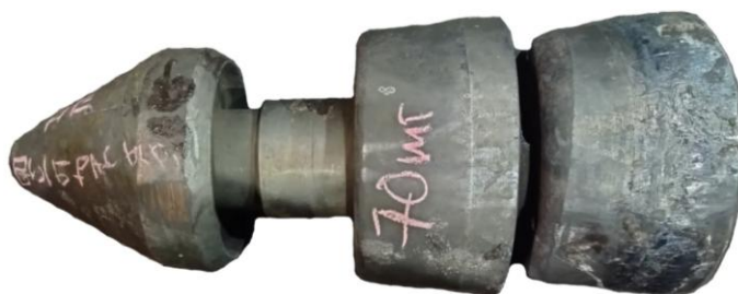
Рисунок 4.18 – Оправочный узел после первого прохода прокатки
