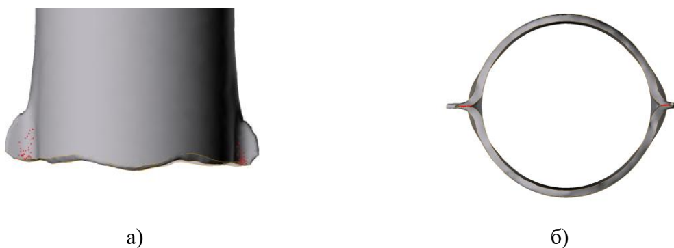
Рисунок 4.3 – 3D модель черновой трубы после второго прохода раскатки на автоматическом стане без установки дополнительной втулки
