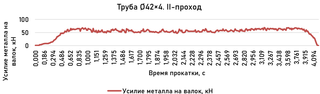
Рисунок 5.21 – Максимальное усилие металла на валок во II-проходе
