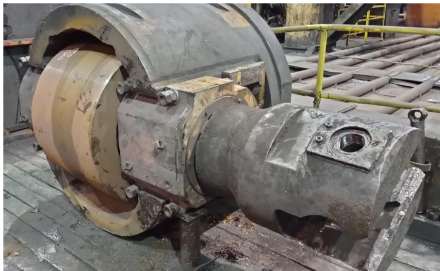
Рисунок 3.12 – Валки прошивного стана ТПА 220 в сборе
