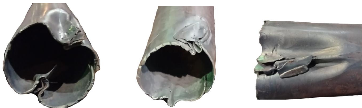
Рисунок 4.13 – Трубы на охлаждающем столе после прокатки на ТПА 220 без дополнительной втулки
