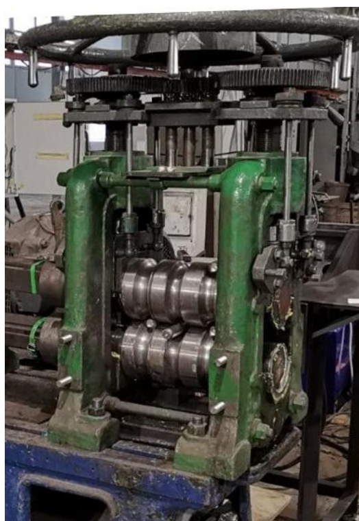
Рисунок 5.22 – Клеть ДУО-210 с калиброванными валками
