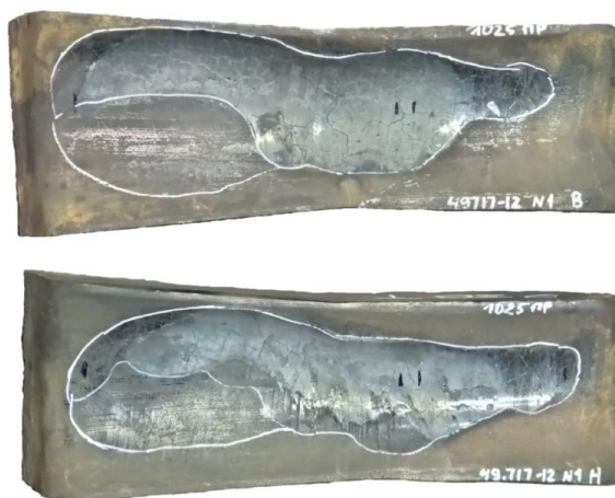
Рисунок 3.18 – Направляющая линейка прошивного стана ТПА 220 после 1025 проходов
