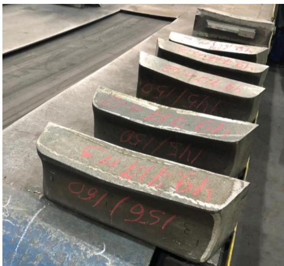
Рисунок 3.14 – Направляющие линейки, изготовленные по технологии литья с применением ХТС
