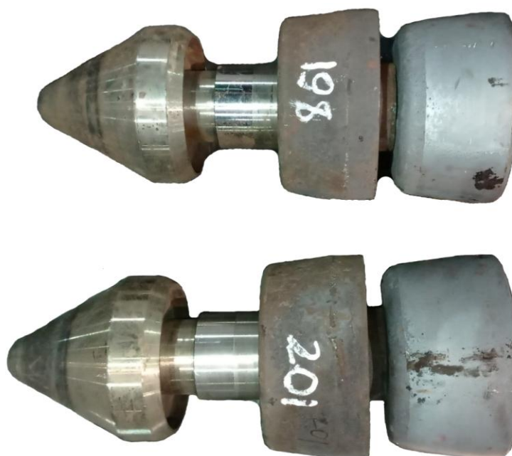
Рисунок 4.12 – Спутник с оправкой и втулкой в сборе ТПА 220
