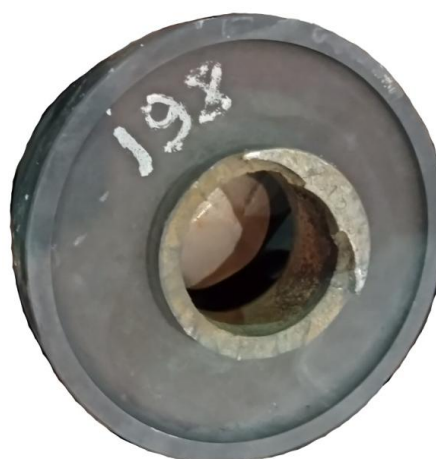
Рисунок 4.17 – Втулка с первого прохода после 70 проходов
