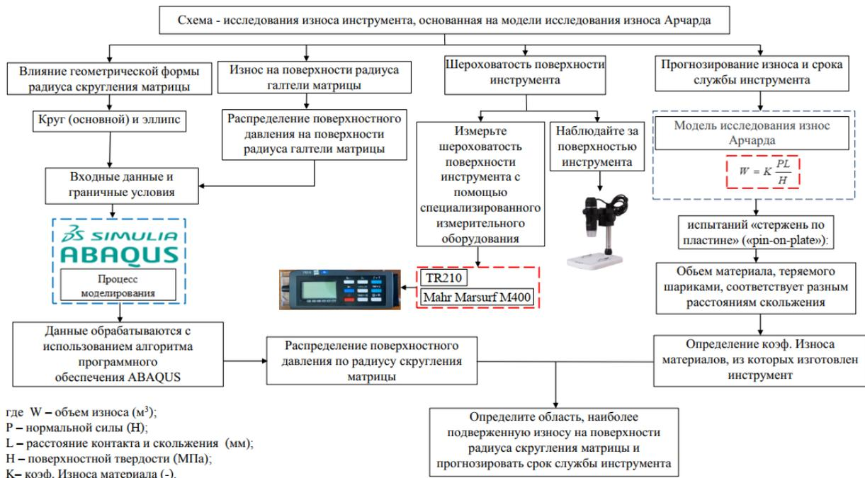
Рисунок 13. Общая схема проведения исследования износа инструмента по формуле износа Арчарда
