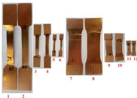
Рисунок 2. Непропорциональные (№1...6) и пропорциональные (№7...12) образцы после проведения испытаний на одноосное растяжение (из М1)
