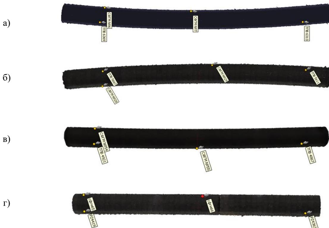
Рисунок 15 - Построенные ЦМТ 50-метровых участков перегонного тоннеля с опорными знаками: а)  $R=350\text{м}$ ; б)  $R=500\text{м}$ ; в)  $R=1000\text{м}$ ; г)  $R=3000\text{м}$
