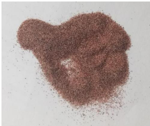
Рисунок 11. Гранатовый абразив Blastrite Microblast Garnet
