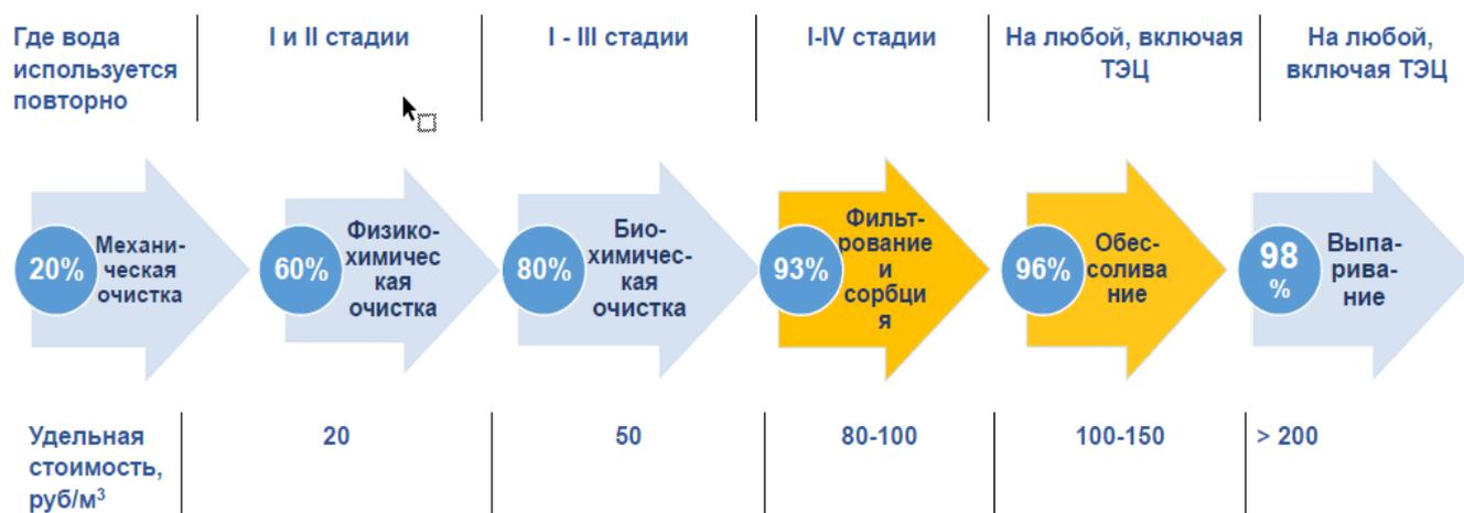
Рисунок 1.10 - Полный цикл очистки сточных вод для организации замкнутых оборотных систем, % возврата воды в производство, удельная стоимость куб. м очищенной воды
