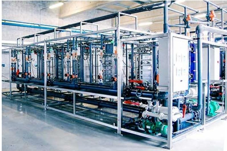
Рисунок 4.20 – Станция опреснения с использованием электродиализаторов [473]
