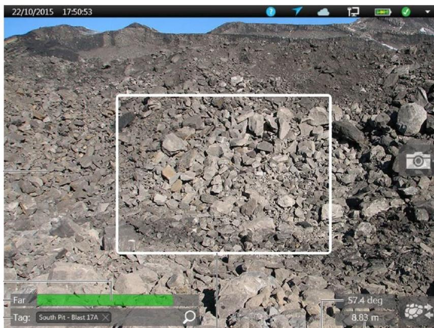
Рисунок 2.7 – Пример отображения интерфейса в планшете PortaMetrics при фотографировании активного забоя
