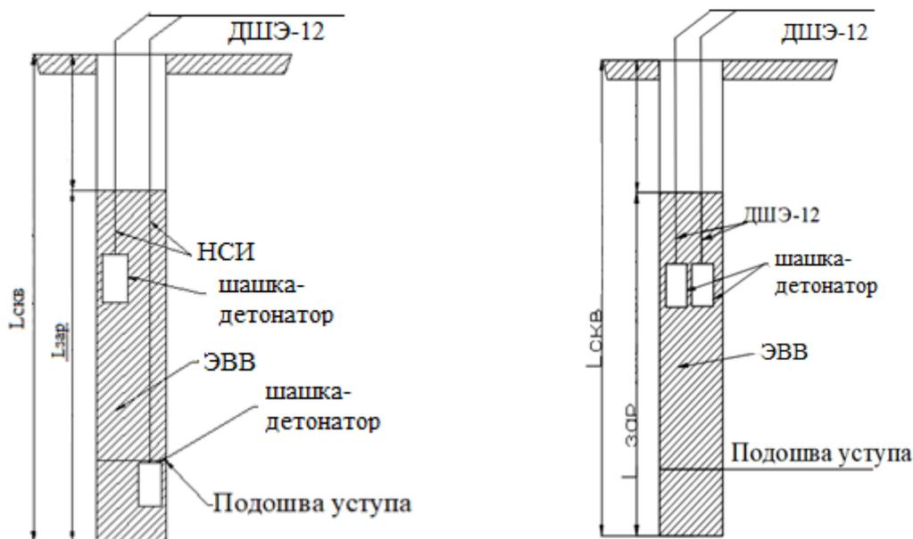
Рисунок 4.1 – Схема конструкции заряда ЭВВ, инициированного средствами инициирования а) НСИ в сочетании с ДШЭ-12; б) ДШЭ-12.
