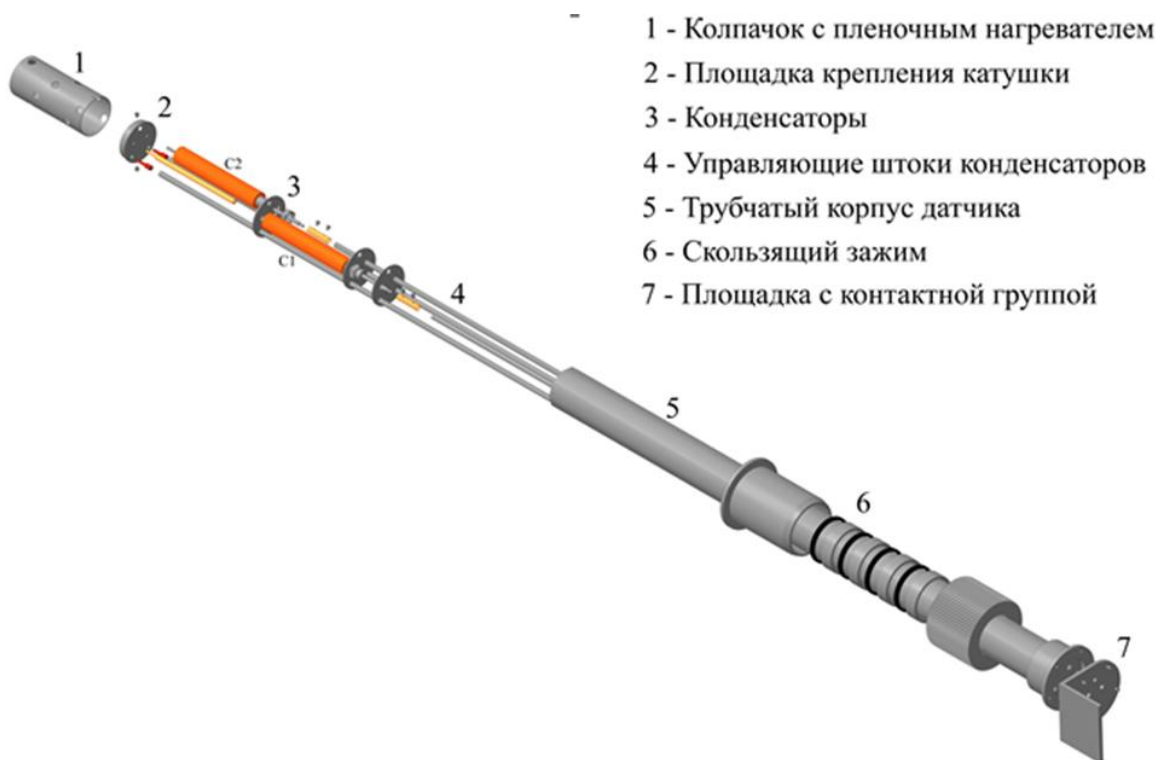
Рисунок 4 – Датчик VT132H и его составляющие части
