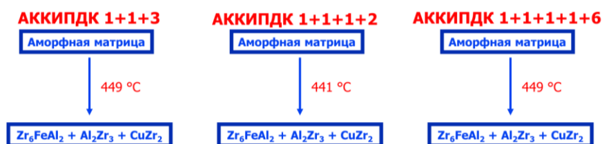
Рисунок 4.4.5. – Схематичное изображение процесса кристаллизации сплава Zr_{62.5}Cu_{22.5}Al_{10}Fe_5 в различных АК-ИПДК состояниях
