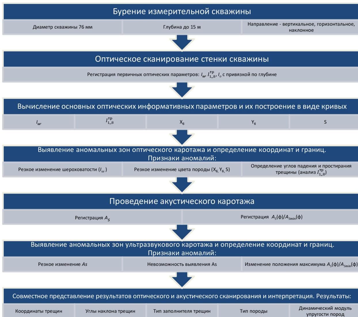
Рисунок 4 – Алгоритм проведения комплексного оптико-акустического каротажа скважин
