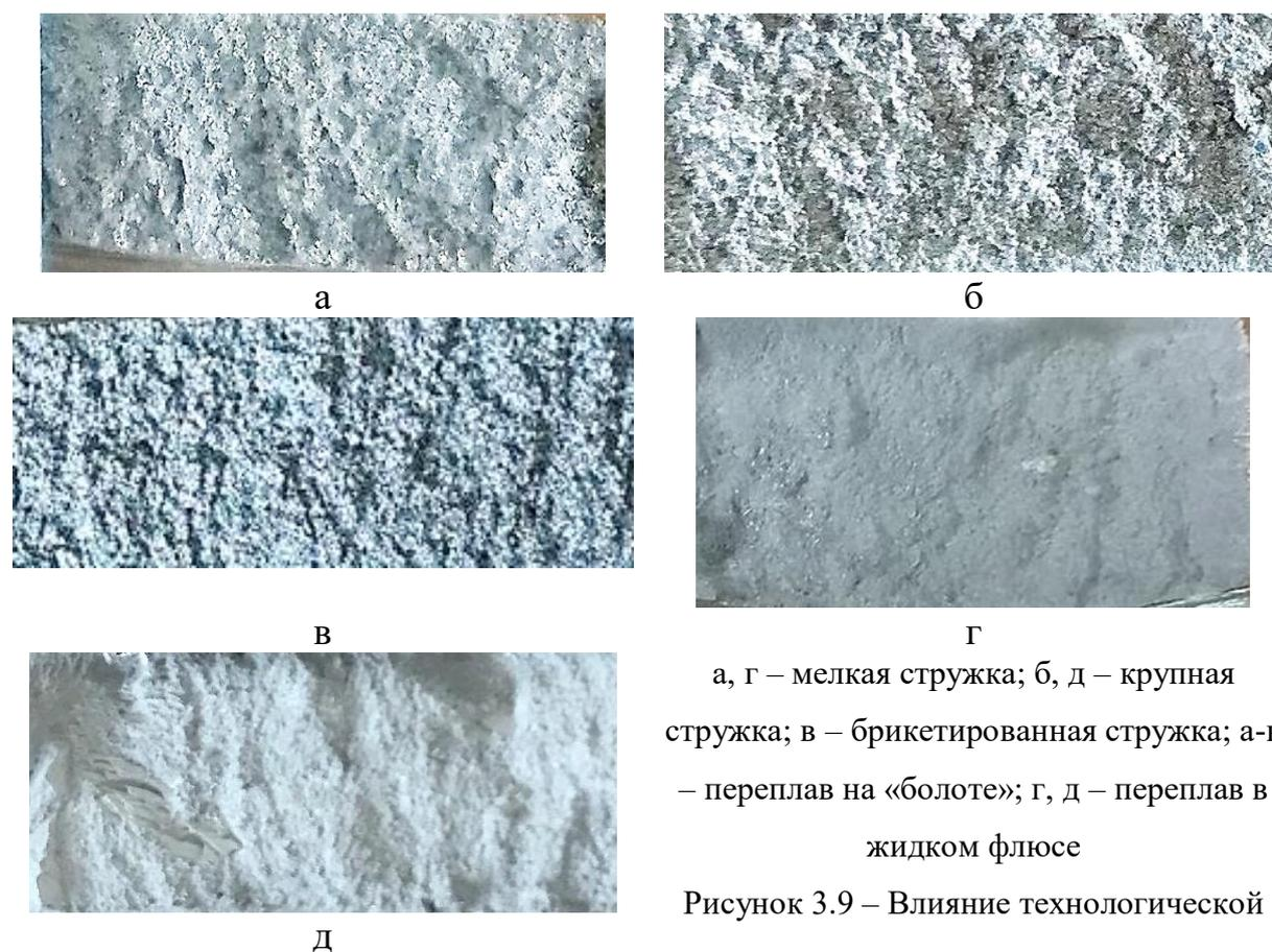
а, г – мелкая стружка; б, д – крупная стружка; в – брикетированная стружка; а-в – переплав на «болоте»; г, д – переплав в жидком флюсе
