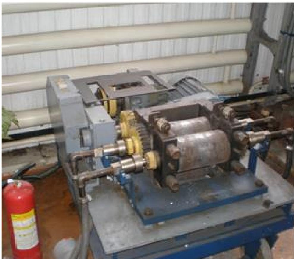
Рисунок 2.4 - Водоохлаждаемый валковый кристаллизатор
