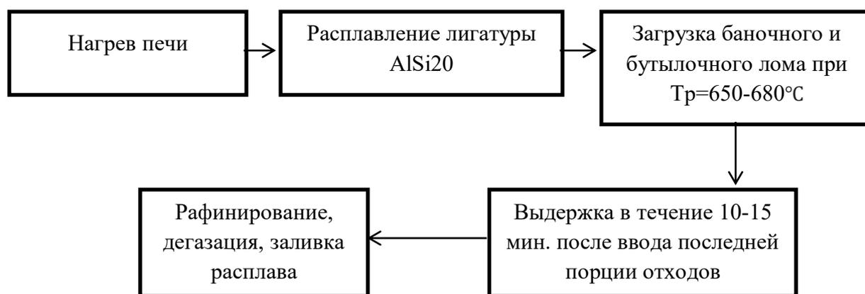
Рисунок 4.20 – Технологическая схема синтезирования сплава АК12
