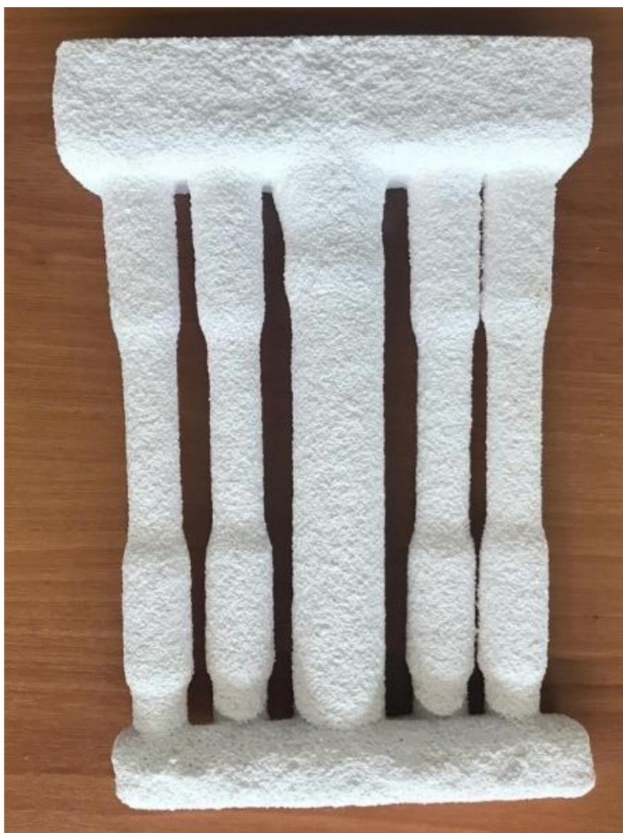
Рисунок 5.9 – Огнеупорная керамическая форма для получения отдельно отлитых образцов на механические испытания
