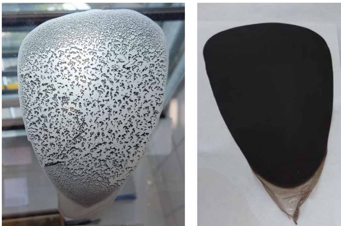
Рисунок 3.5 – Распределение наночастиц в композите ПВДФ/CFO в зависимости от количества растворителя: избыток ДМФА – 1:10 (слева), оптимальное содержание ДМФА – 1:8 (справа).
