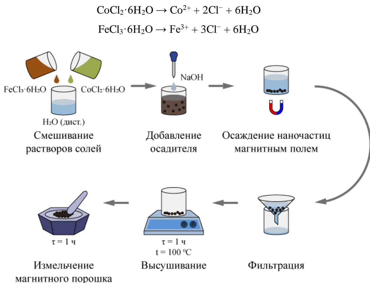
Рисунок 1.5 – Технологическая схема получения МНЧ методом соосаждения.
