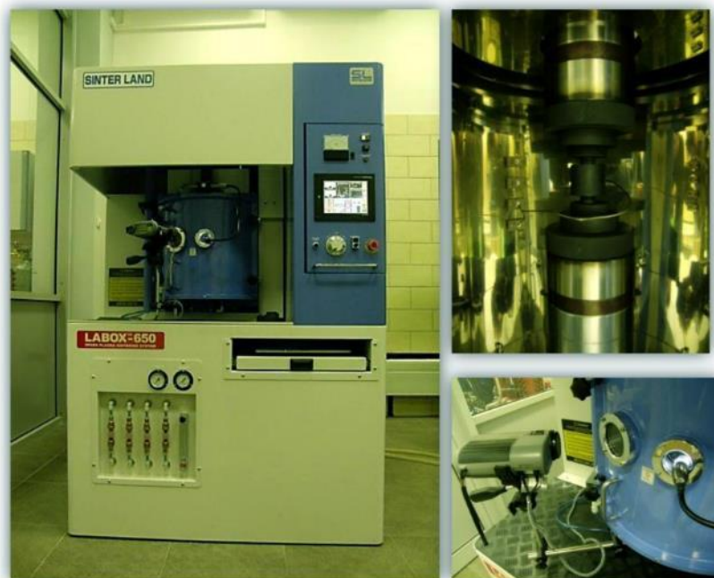
Рисунок 68 – Установка искрового плазменного спекания Spark Plasma Sintering – Labox 650, рабочая камера и пирометр
