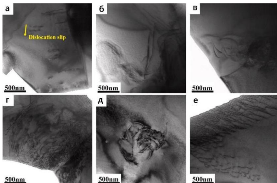
Рисунок 138 – Дислокационное поведение / структура ВЭК-Hf после испытаний на ползучесть: (а) и (б) НТ2000, 1600 °С/300 МПа; (в) и (г) НТ2100, 1600 °С/200 МПа; (д) и (е) НТ2100, 1600 °С/250 МПа
