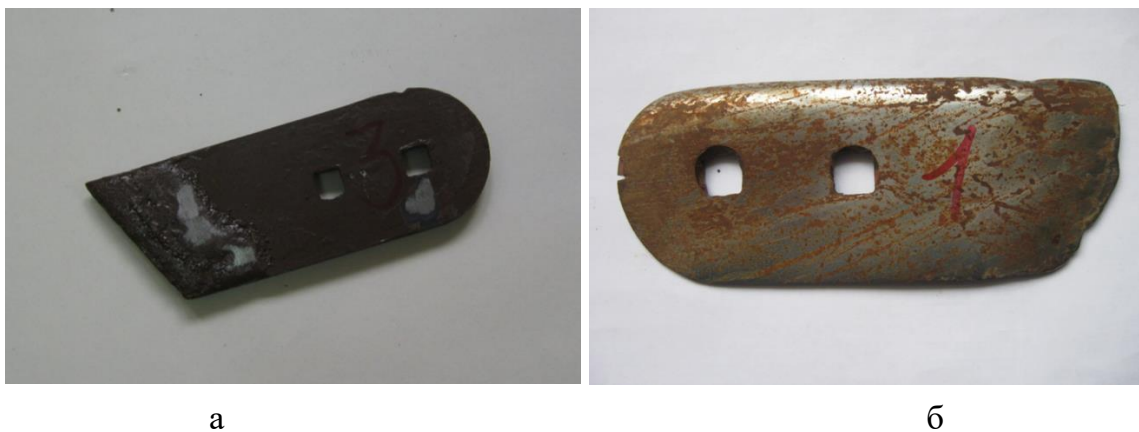
Рис. 4.15. Долото (тыльная сторона) до (а) и после (б) эксплуатационно-полевых испытаний
