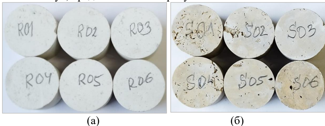
Рисунок 5 – Фото образцов известняка (а) со станции Рижская БКЛ и образцов доломита со станции Суворовская до испытаний на предел прочности при растяжении
